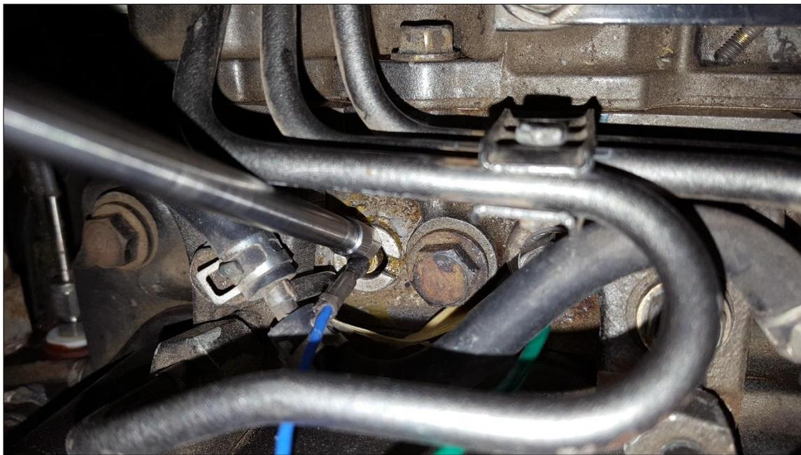
Ilustración 7: Herramienta necesaria para la instalación del sensor presión cilindro
